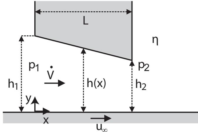
Durch eine Labyrinthdichtung der Länge  $L$  und der Breite  $B$ , die normal zur  $x$ - $y$ -Ebene ist, strömt ein inkompressibles Schmiermittel mit konstanter Viskosität  $\eta$ . Die Wand bewegt sich mit der Geschwindigkeit  $u_\infty$  relativ zur Dichtung. Die Höhe des Spaltes nimmt linear von  $h_1$  auf  $h_2$  ab. Für stationäre, schleichende Strömungen lautet die Impulsgleichung in  $x$ -Richtung
