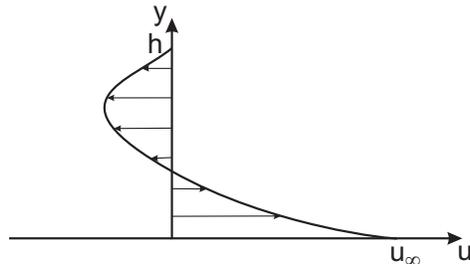
Der Geschwindigkeitsverlauf ist für beide Zustände gleich, da von einer stationären, ausgebildeten Strömung ausgegangen wird und daher eine Rückströmung vorliegen muss.
