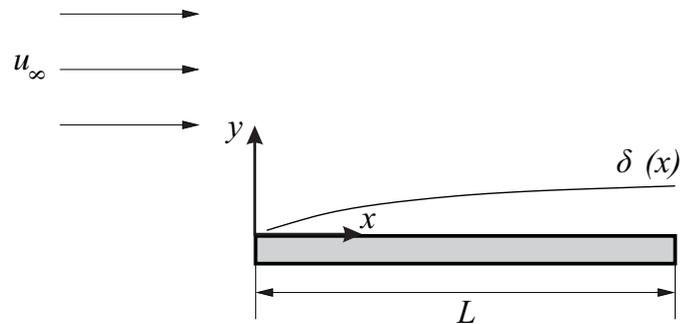
Für die Geschwindigkeitsverteilung in der turbulenten Grenzschicht einer mit der Geschwindigkeit  $u_\infty$  längs angeströmten ebenen Platte (Länge  $L$ ) gilt näherungsweise
