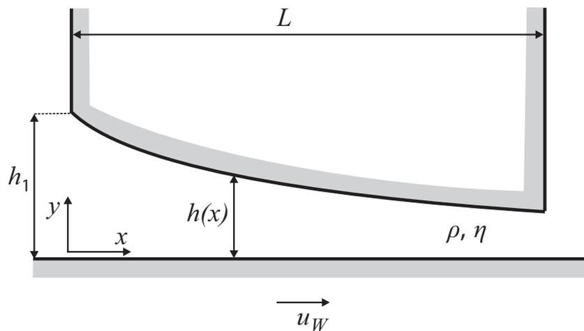
Für eine zweidimensionale, stationäre, inkompressible Strömung eines Fluids mit konstanter Dichte  $\rho$  und dynamischer Zähigkeit  $\eta$  ist die  $x$ -Impulsgleichung in dimensionsbehafteter Form gegeben
