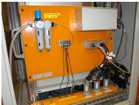
Scanivalve RAD3200 base: kann bis zu 128 Kanäle sequentiell messen (-> nur zeitgemittelte Signale werden ermittelt)
