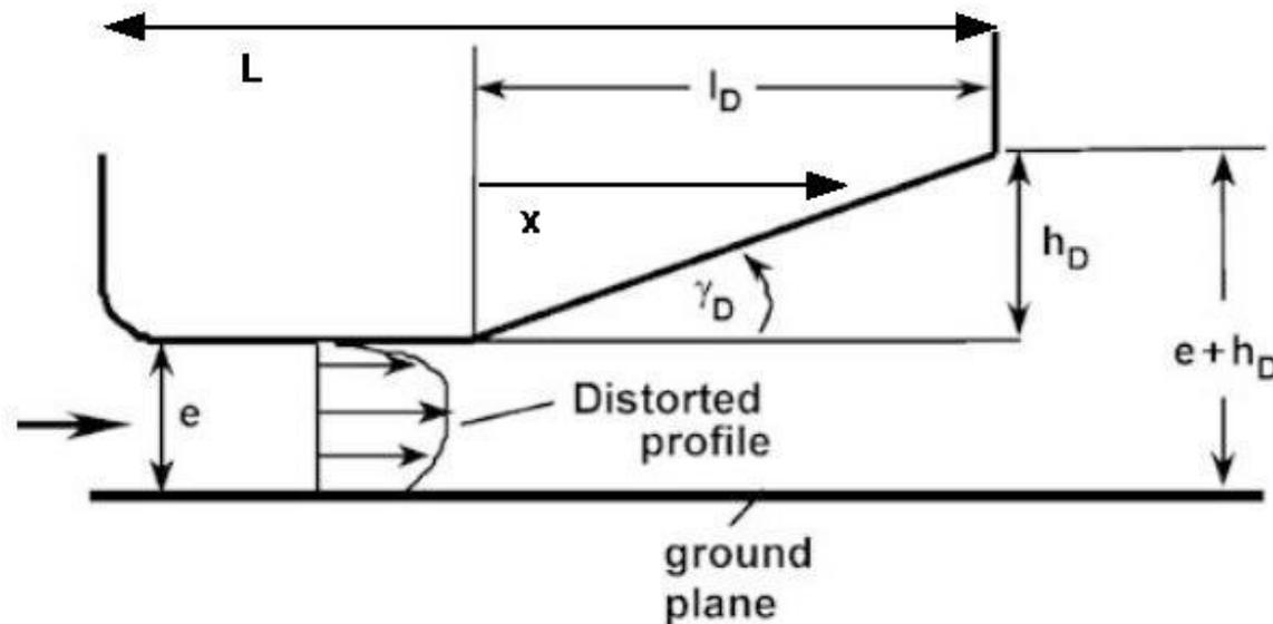
Am Unterboden eines Rennfahrzeuges ist ein Diffusor angebracht. Die Strömung sei reibungsfrei und der Winkel  $\gamma_D$  sei klein.
