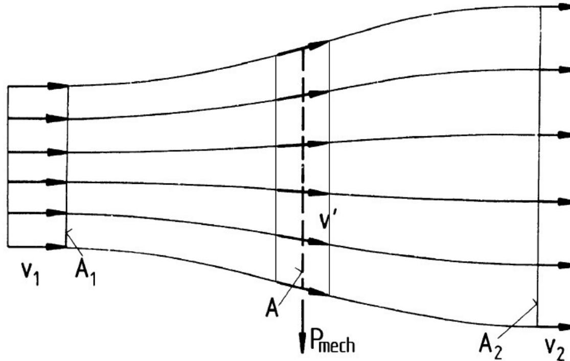
2. Berechnen Sie die Geschwindigkeit in der Rotorebene!
