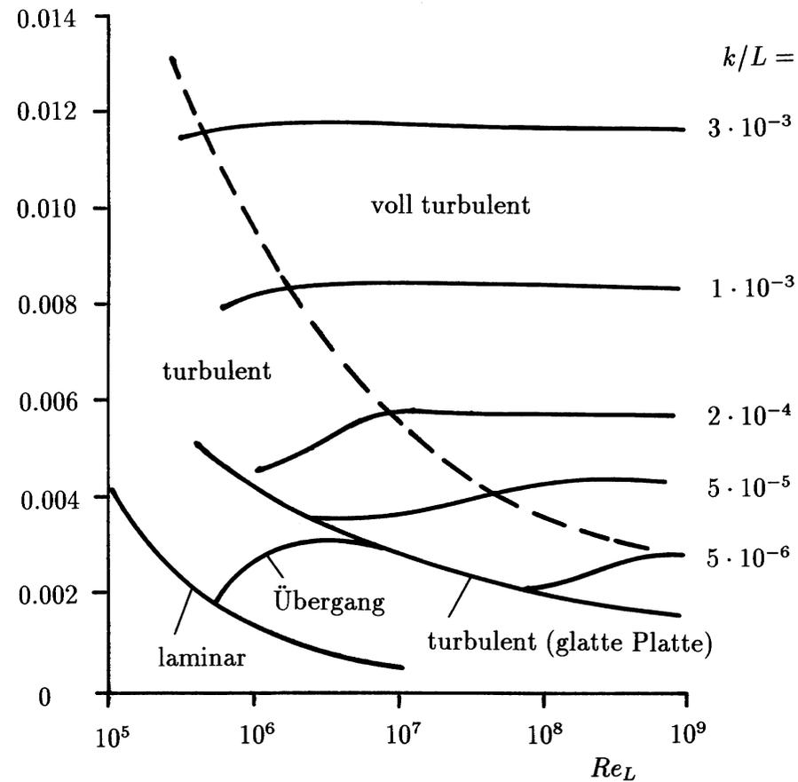
Widerstandsbeiwert für die längsangeströmte ebene Platte
