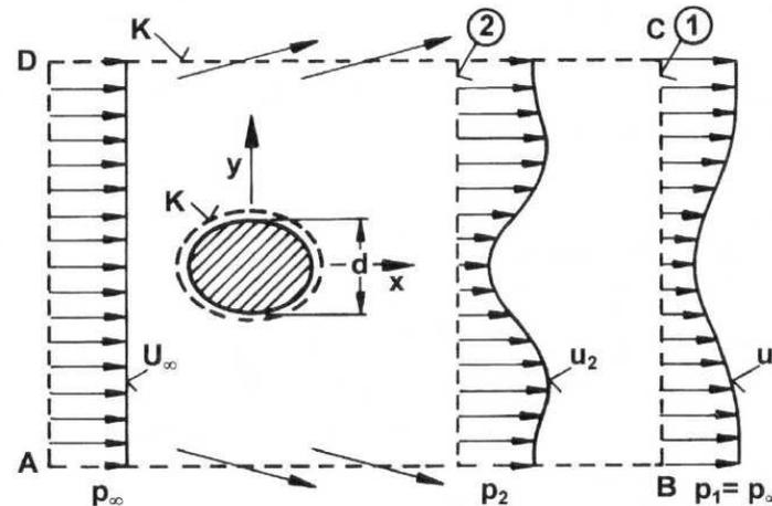
Die Geschwindigkeitsverteilung im Strömungsfeld um einen stumpfen Körper wurde vermessen. Aus den Daten wurde analysiert, dass sich das symmetrische Feld in der folgenden Form schreiben lässt:
