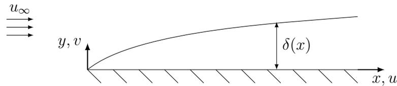
Das dabei entstehende Geschwindigkeitsprofil in der Grenzschicht wird vollkommen turbulent angenommen und durch ein  $\frac{1}{7}$  Potenzgesetz angenähert
