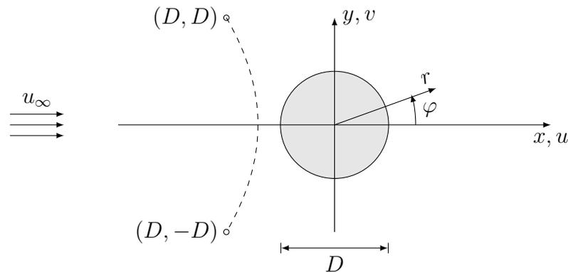
Das Strömungsfeld soll mithilfe der Potentialtheorie beschrieben werden. Hierbei darf angenommen werden, dass das Netz keinen Einfluss auf die Strömung hat.
