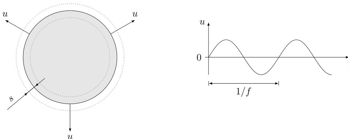
Durch die Oszillation werden Schallwellen erzeugt, die sich radial von der Kugel ausbreiten.
