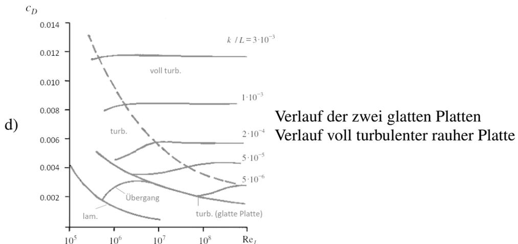
e) Vorteil: höhere Vermischung wichtig für Wärmeaustausch oder Mischung unterschiedlicher Fluide, erhöhte Ablösungstoleranz durch stärkeren Impulsaustausch in der Grenzschicht
