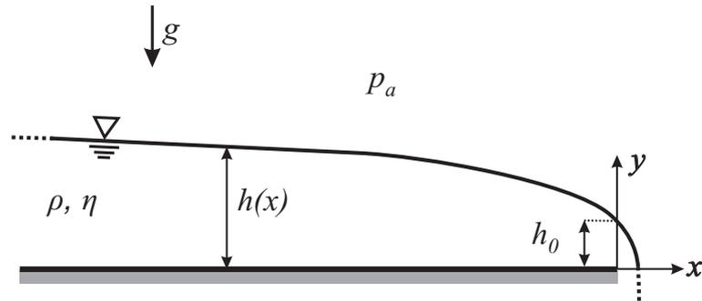
Über eine große, horizontale Platte der Tiefe  $B$  fließt ein Flüssigkeitsfilm. Die Strömung wird durch Zufuhr eines konstanten Volumenstroms  $\dot{V}$  weit von der Plattenhinterkante entfernt aufrecht erhalten. An der Plattenhinterkante strömt die Flüssigkeit ab. Die schleichende Strömung im Flüssigkeitsfilm wird durch die Differentialgleichungen
