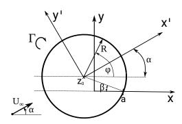
Ein exzentrisch gelagerter, rotierender Zylinder, der unter einem Anstellwinkel  $\alpha$  mit der Geschwindigkeit  $U_{\infty}$  angeströmt wird, soll mithilfe der Abbildungsfunktion nach Zhukhovski abgebildet werden.
