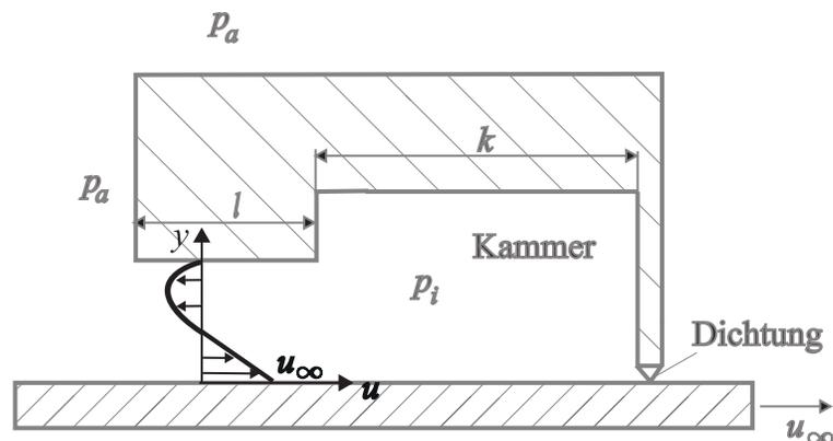
c) Der Volumenstrom durch den Spalt ist Null, da die Dichtung das Wegfließen der Flüssigkeit verhindert.
