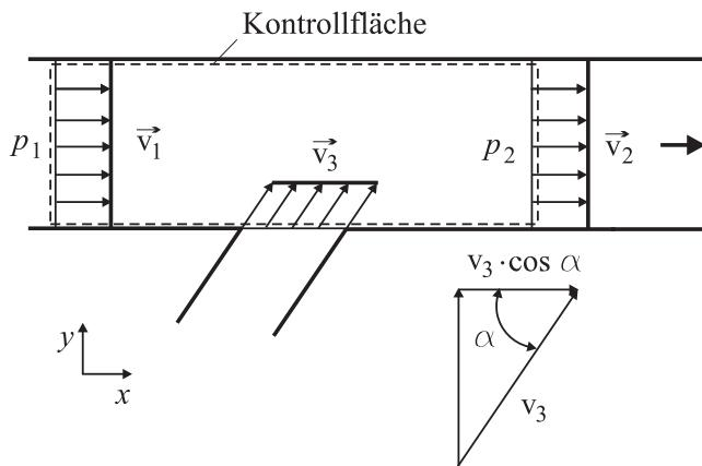
$$\text{conti: } v_1 A + v_3 A_3 = v_2 A \quad \text{mit} \quad A_3 = \frac{1}{4} A$$
