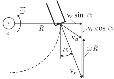
$$\vec{v}_a = v_{absolut} \quad \vec{v}_r = v_{relativ} \quad \vec{\omega} \cdot R = v_{Fahrzeug} \quad \vec{v}_a = \vec{v}_r + \vec{\omega}R$$
