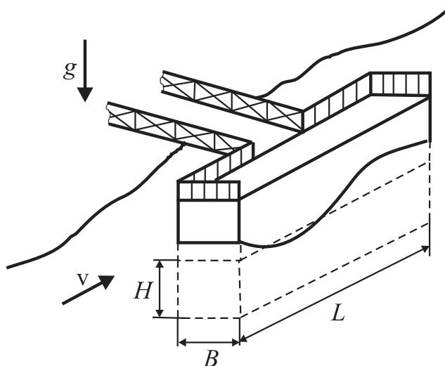
$$L = 3,6 \text{ m} \quad B = 1,2 \text{ m} \quad H = 2,7 \text{ m} \quad v = 3 \text{ m/s}$$
