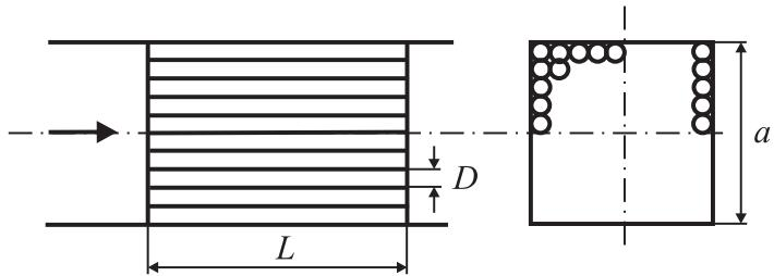
$$\dot{V} = 0,01 \text{ m}^3/\text{s} \quad L = 0,5 \text{ m} \quad a = 0,1 \text{ m} \quad D = 0,01 \text{ m} \quad \rho = 10^3 \text{ kg/m}^3 \quad \eta = 10^{-3} \text{ Ns/m}^2$$
