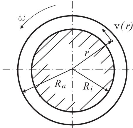
$$R_a = 0,11 \text{ m} \quad R_i = 0,1 \text{ m} \quad L = 0,1 \text{ m} \quad \omega = 10 \text{ s}^{-1} \quad M_z = 7,246 \cdot 10^{-3} \text{ Nm}$$
