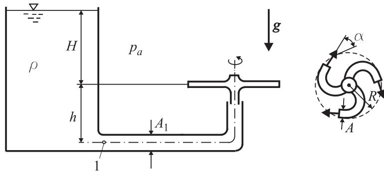
$$H = 10 \text{ m} \quad R = 0,5 \text{ m} \quad h = 1 \text{ m} \quad A = 0,5 \cdot 10^{-4} \text{ m}^2 \quad A_1 = 1,5 \cdot 10^{-4} \text{ m}^2 \quad \alpha = 30^\circ$$
