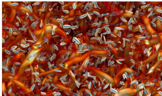
Links: Stromlinien-Visualisierung eines umströmten angestellten Partikels. Die nicht-sphärische Form eines Biomasse-Partikels wird durch einen Ellipsoiden approximiert.
