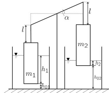
Waagebalken um Winkel  $\alpha$  ausgelenkt:
