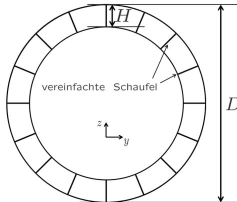
Die beiden nachfolgenden Gitterkonfigurationen sollen hinsichtlich ihres Druckverlustes und ihrer Drehmomentübertragung untersucht werden. Nehmen Sie hierfür an, dass die Höhe  $H$  der Schaufeln klein gegenüber dem Durchmesser  $D$  ist, so dass die Strömung als eben betrachtet werden kann.
