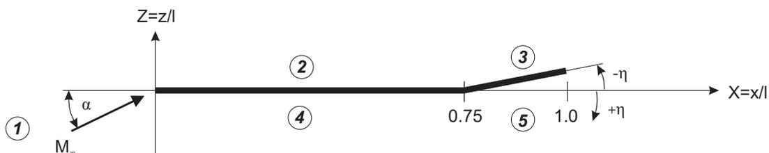
Der Anstellwinkel beträgt  $\alpha = 10^\circ$  und die Klappe ist um  $\eta = -12^\circ$  nach oben ausgeschlagen. Die Machzahl der freien Anströmung ist  $M_\infty = 3.0$ .
