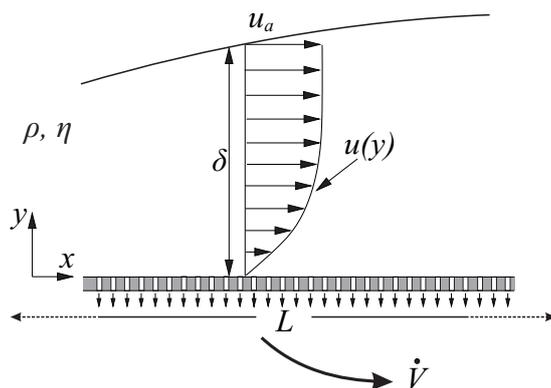
An einer längs angeströmten ebenen Platte (Breite  $B$ ) bildet sich eine laminare, inkompressible Grenzschicht aus. Durch gleichmäßig in der Platte verteilte Bohrungen wird mit konstanter Geschwindigkeit über der Länge  $L$  der Volumenstrom  $\dot{V}$  abgesaugt. Für das Geschwindigkeitsprofil in  $x$ -Richtung in der Grenzschicht gilt der Polynomansatz:
