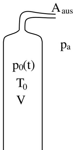
Eine Druckluftflasche (Volumen  $V$ ) ist mit Luft ( $p_0, T_0, \gamma$ ) gefüllt. Infolge eines Montagefehlers reißt der Manometerverschluss ab ( $t_0 = 0$ ), so dass die Luft in die Umgebung ausströmt (Umgebungsdruck  $p_a$ ).
