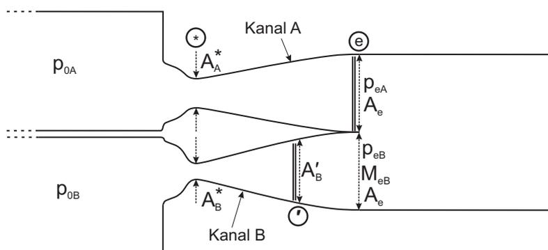
Um die Interaktion zweier Überschallströmungen zu untersuchen, werden zwei Überschallwindkanäle  $A$  und  $B$  wie in der Skizze gezeigt parallel betrieben. Ab dem Punkt  $e$  werden die zwei getrennten Kanäle zu einem Kanal vereinigt. Im Betrieb stellt sich durch einen Fehler in Kanal  $A$  im Querschnitt  $A_e$  direkt vor der Vereinigung der Kanäle sowie in Kanal  $B$  weiter stromauf im Querschnitt  $A'_B$  ein senkrechter Verdichtungsstoß ein.
