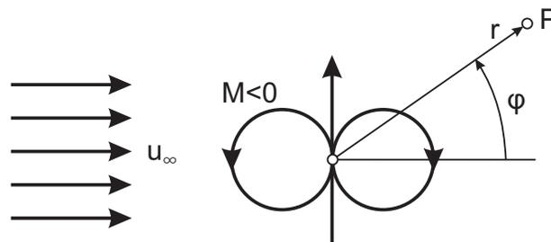
Gegeben sei ein Dipol, der mit seiner Achse normal zur Richtung einer Parallelströmung steht. Der Dipol mit Dipolmoment  $M < 0$  sei im Ursprung eines Polarkoordinatensystems plaziert.
