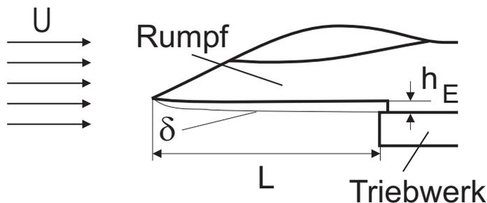
Ein Flugzeug wird von einem Strahltriebwerk angetrieben, dessen Einlauf sich auf der Unterseite befindet. Es wird ein Unterschallflug mit der Geschwindigkeit  $U$  angenommen. Betrachten Sie die Grenzschicht, die sich an der Unterseite des Rumpfes ausbildet. Das Geschwindigkeitsprofil in der Grenzschicht lässt sich durch folgenden Polynomansatz darstellen:
