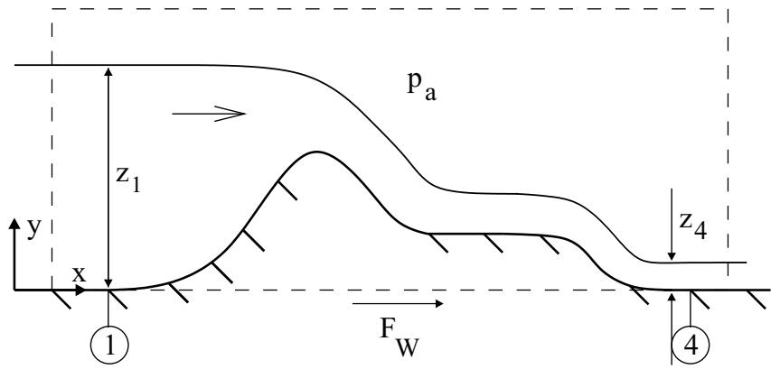
$$-v_1^2 z_1 B - B \int_0^{z_1} p_1(z) dz + \rho v_4^2 z_4 B + B \int_0^{z_4} p_4(z) dz + p_a B(z_1 - z_4) + F_W = 0$$
