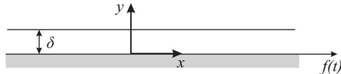
Eine unendlich ausgedehnte ebene Platte schwingt in  $x$ -Richtung mit der Geschwindigkeit  $f(t) = U_0 \cos(\omega t)$ . Dabei entsteht eine mitschwingende Strömungsschicht mit konstanter Dicke  $\delta$ . Zur Untersuchung dieses Problems sollen die folgenden Erhaltungsgleichungen für Masse und Impuls vereinfacht werden.
